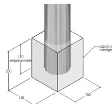
**Para una correcta instalación es imprescindible rellenar completamente el interior con hormigón y es aconsejable insertar varillas de rea.**
